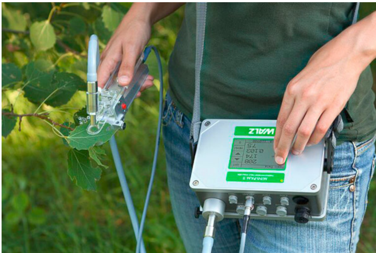
使用MINI-PAM荧光仪测量叶绿素荧光
