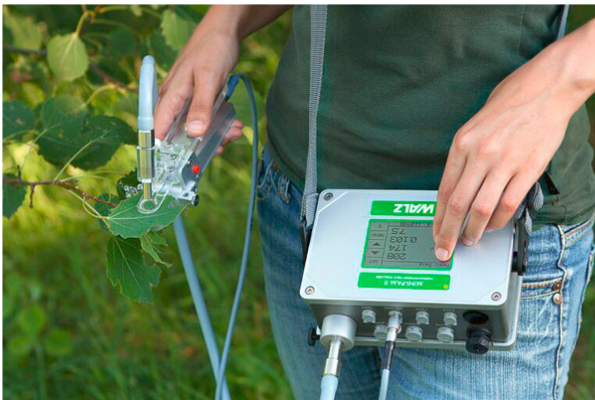
MINI-PAM fluorometre ile klorofil floresansının ölçülmesi
