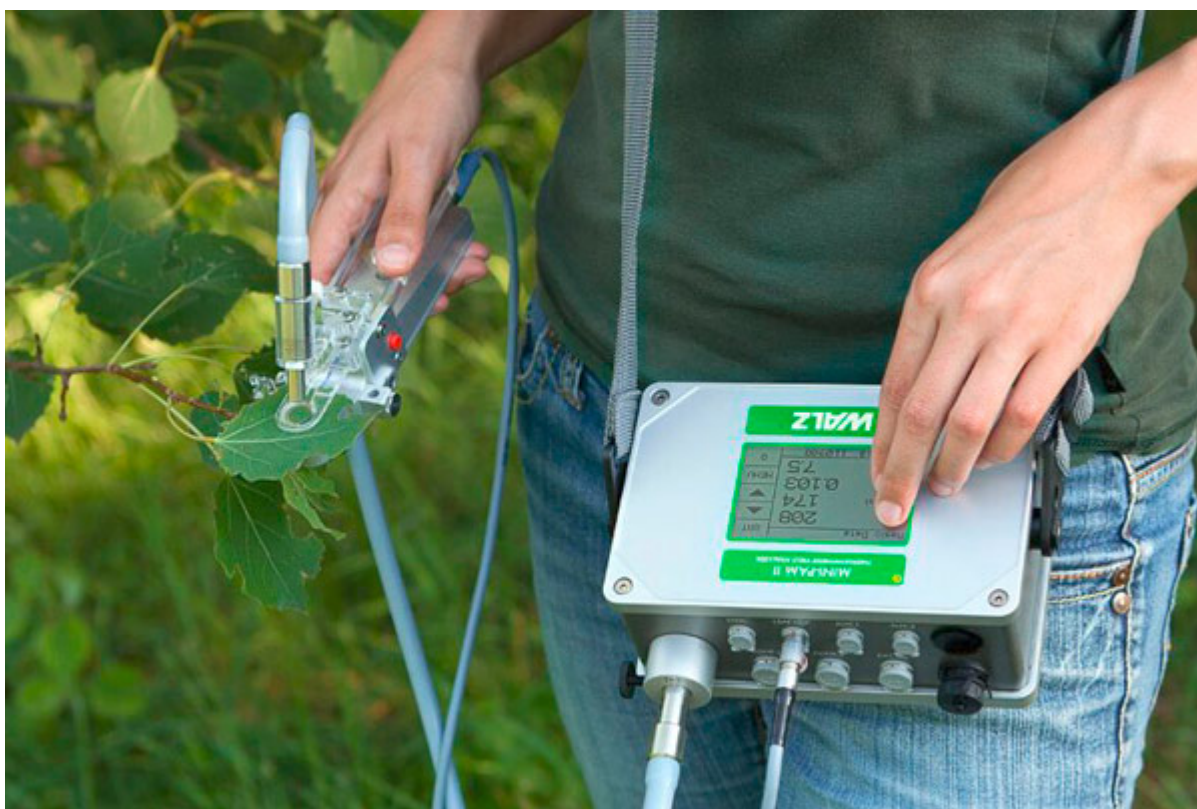
Măsurarea fluorescenței clorofilei cu fluorometrul MINI-PAM
