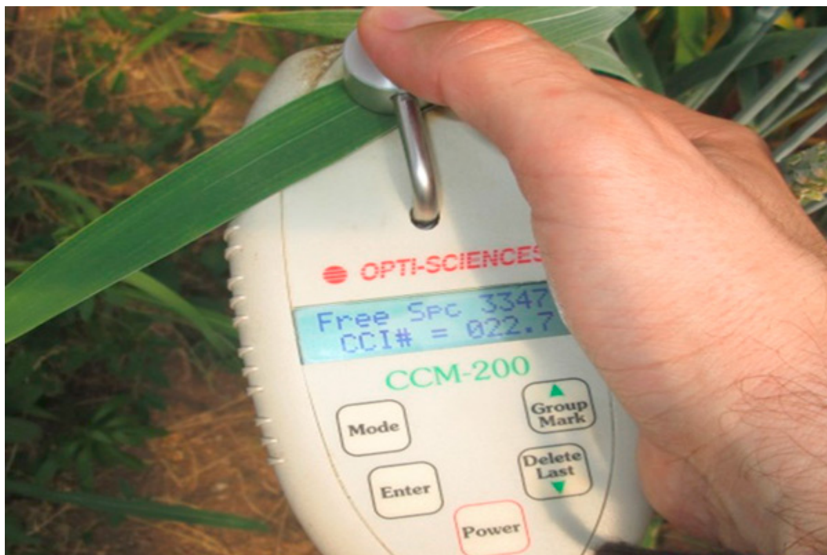
Mesure avec un chlorophyllemètre
